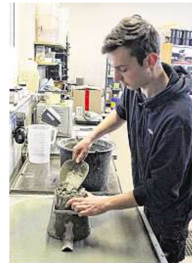
Joel Kahls Job als Baustoffprüfer ist es unter anderem, das so genannte Ausbreitmaß zu ermitteln, um so die Konsistenz des Betons zu überprüfen.
