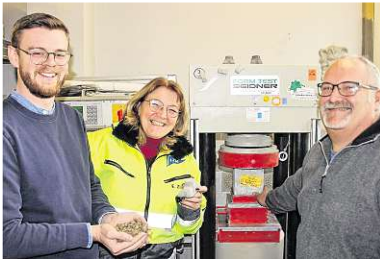
Aus Wasser, Sand und Gestein, wie es Manuel Baumann in der Hand hält, wird unter Zugabe von Zement Beton. Je nach Mischungsverhältnis „kocht“ Betontechnologe Josef Nachtmann daraus auch schon mal ein Mini-Auto, wie es Elisabeth Ziegler zeigt. In eine Presse werden quadratische Proben aller Betonmischungen auf ihre Festigkeit hin getestet.
