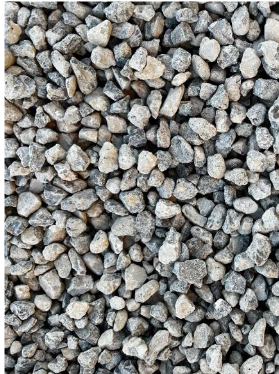
Baustoffgemisch: recycelter Beton
